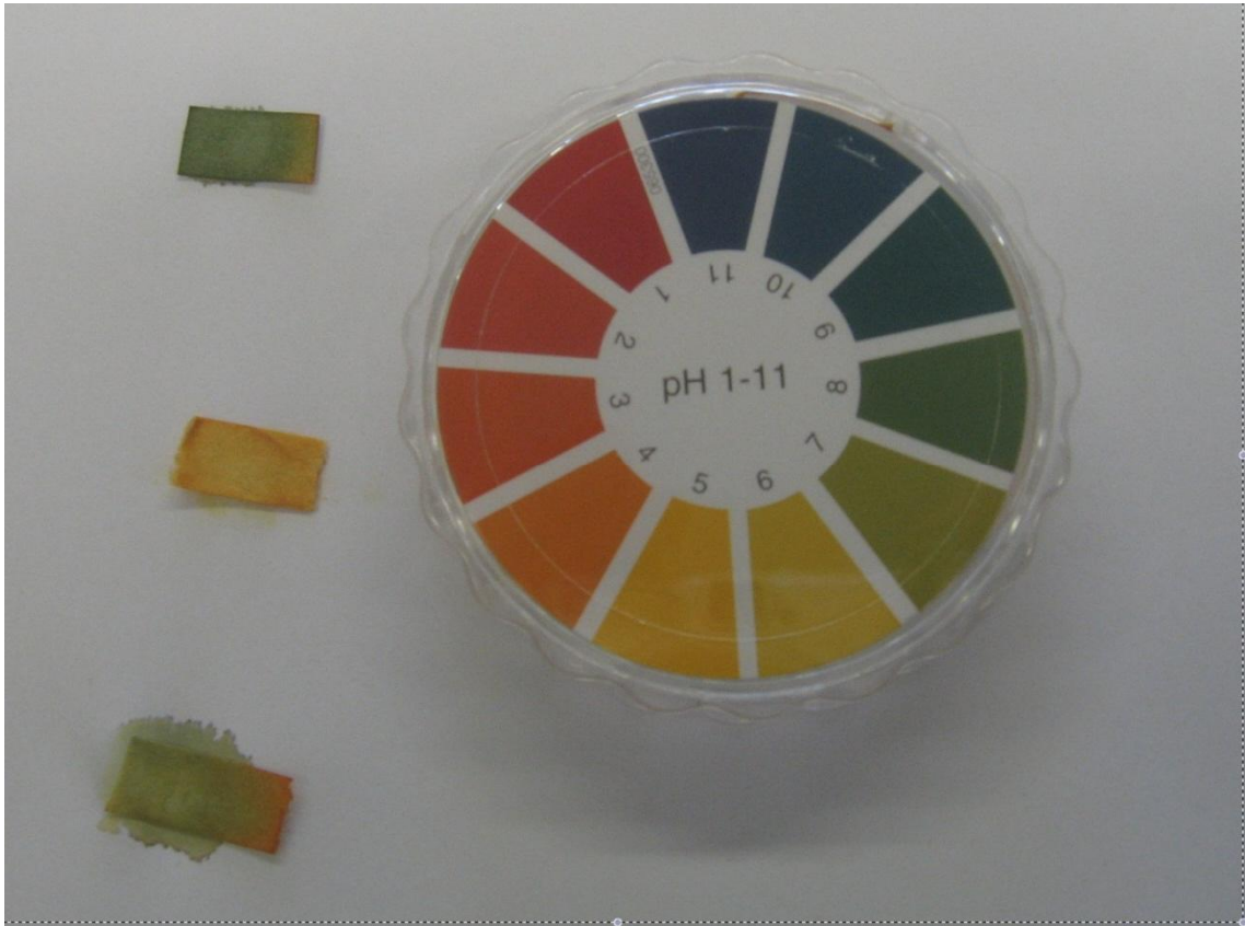
Kuva 2. Syljen happamuus ennen virvoitusjuoman nauttimista (ylin pH-paperi), sen jälkeen (keskimmäinen pH-paperi) ja ksylitolipurukumin pureskelun jälkeen (alin pH-paperi).
