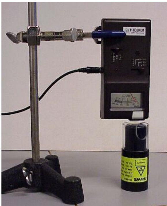
Kuva 11. U-238 -preparaatti ja tietokoneeseen kytketty geigermittari
