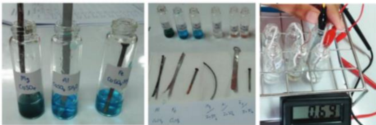
Kuva 3. Kaksi vasemmanpuoleisinta kuvaa esittävät hapettumis-pelkistymisreaktioita ja oikeanpuoleisin kuva galvaanista kennoa (Supasorn, 2015).
